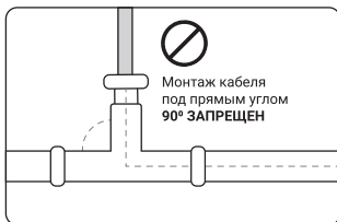
Неправильный монтаж кабеля в трубу
